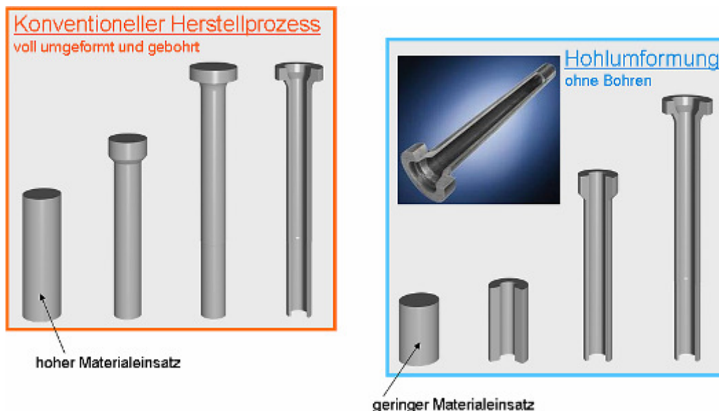
Bild 3: Prozessvergleich Hohlbohren - Hohlumformen
