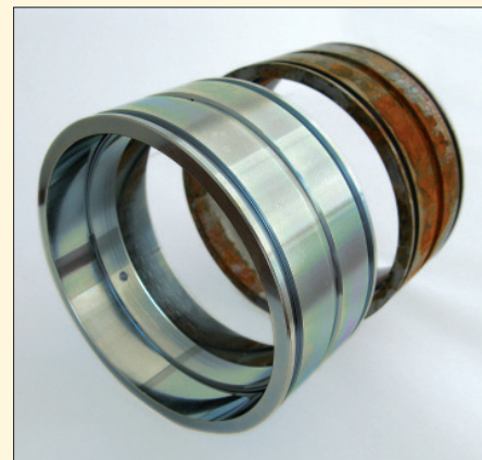
Das beschichtete Teil (vorn) weist auch nach Salzsprühnebeltest keine erkennbaren Korrosionsspuren auf; das unbeschichtete Referenzteil (hinten) ist angerostet
